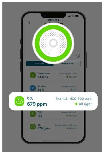
Mit der viaSens App wird der Smart Sensor in Betrieb genommen und in das Mesh Netzwerk integriert. Echtzeit-CO<sub>2</sub>-Werte ergänzen neu die Sensor Fusion aus VOC, Temperatur, Luftfeuchte, Helligkeit, Präsenz und Schallpegel.
