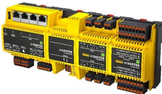
Le concept modulaire du modulo 6 offre une configuration flexible et des performances sur mesure. Les modules sont équipés de bornes à ressort enfichables et peuvent installés l'un à côté de l'autre. Il est possible d'utiliser 24 modules (E/S et COM) au total.
