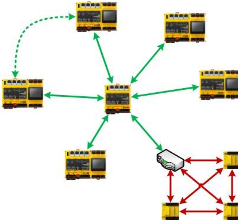
**Figure 4** Topologie Hub-and-Spoke de BACnet/SC. Alors que la communication BACnet/SC est centralisée dans le hub, la communication BACnet/IP est effectuée entre les différentes unités ("station à station") ou via la diffusion.
