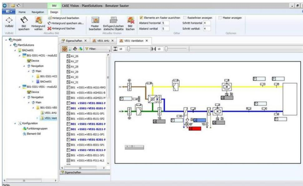
Le programme CASE Vision permet de créer facilement des **arborescences de navigation système** et des diagrammes système **dynamiques** pour diverses applications de visualisation SAUTER.
